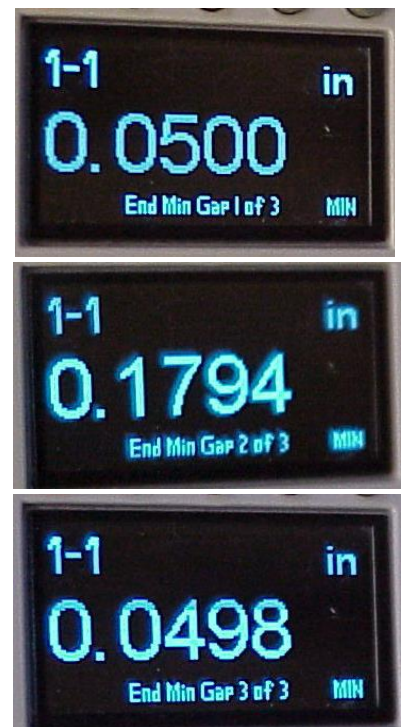
図 2 0 ロール対ロール等隙間の自動測定
