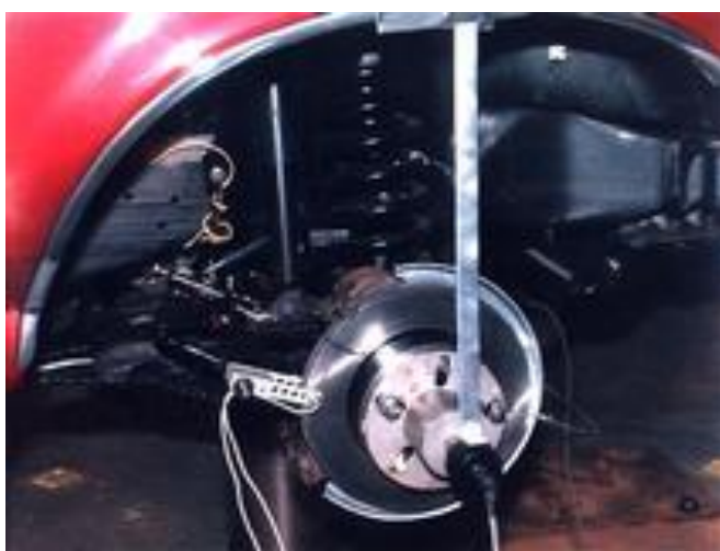
図4 BWS 自動車ブレーキディスク摩耗測定システム
